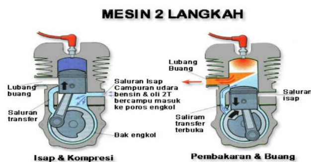
Gambar 2.2 Siklus Kerja Mesin 2-Tak Sumber : https://fastnlow.net/
