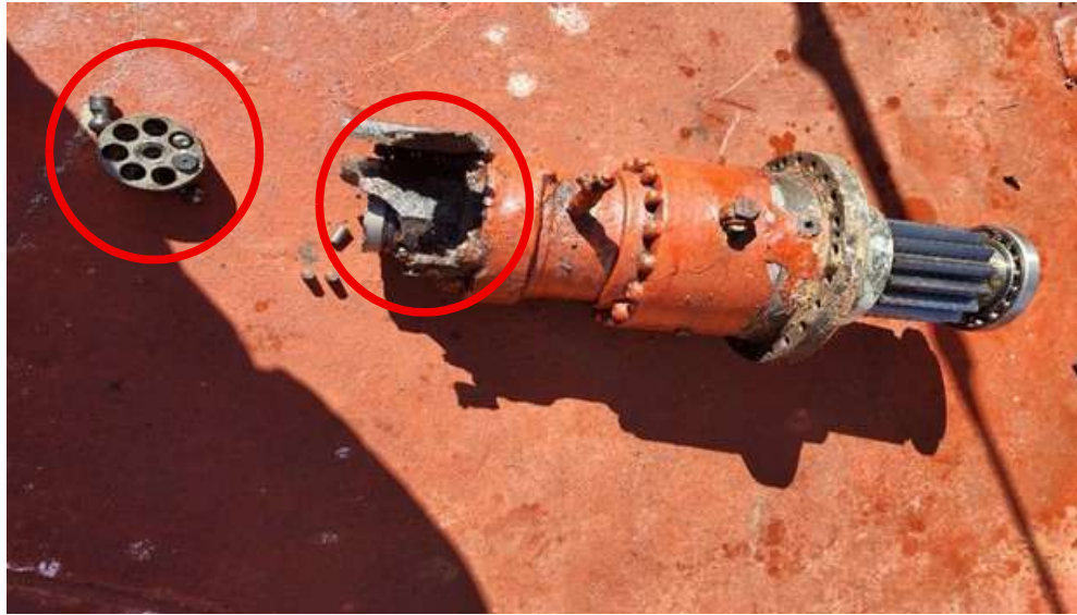
Lampiran 6 Kondisi keausan pada chain stopper
