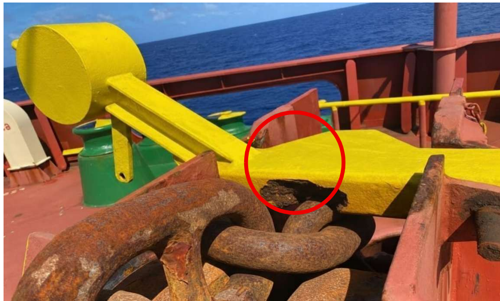
Lampiran 6 Kondisi keausan pada chain stopper
