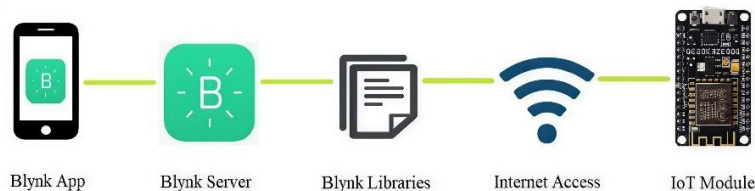
Gambar 2.9 Prinsip Kerja Blynk. (Jamal, dkk., 2020)
