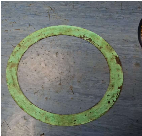
Gambar 1. 2 Packing Reducer yang Rusak
