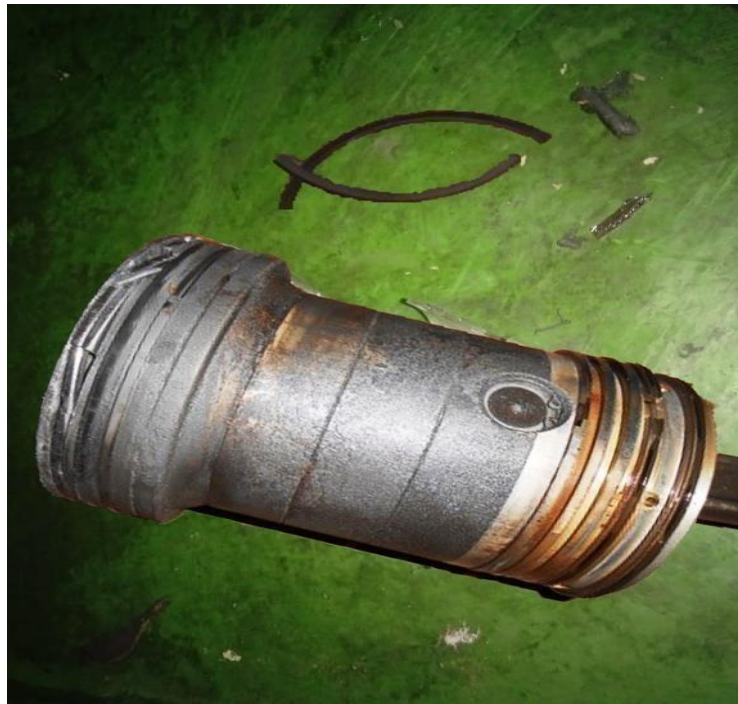
LAMPIRAN 8. Ring Piston Kompresor patah dan Ring Piston Kompresor baru
