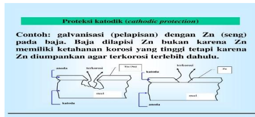
Gambar 3.3 Galvanisasi (pelapisan dengan zinc)
