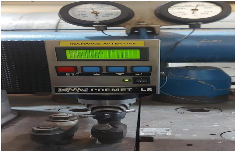
Gambar 1.4 Alat Untuk Mengetahui Engine Performance
