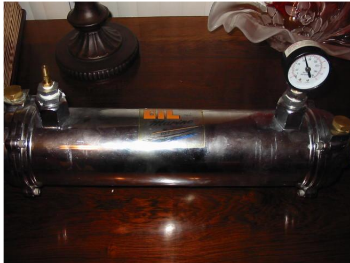
Gambar 3.2 Pengetesan Cooler Menggunakan Tekanan Udara
